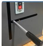
На панели управления машины есть кнопка аварийной остановки и кнопка питания с индикатором для запуска - остановки.
