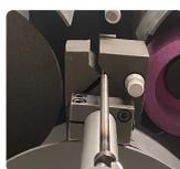
Мощный и быстрый механизм зажима с помощью тисков обеспечивает скорость и удобство работы. С помощью алмазного карандаша для правки камня, чашечный камень может быть легко заточен.
