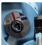
Станок способен резать толкатели диаметром от 1 до 24мм. На направляющей установлен микрометр. Благодаря ему вы можете резать толкатели длиной от 60 до 325мм (опционально до 600мм).
